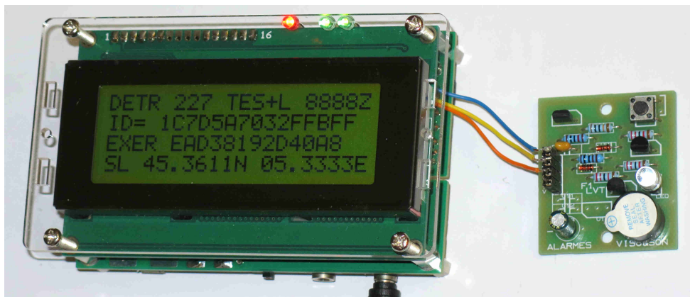
Photo 4 : Le module « Alarme Visuelle et Sonore » relié au décodeur
