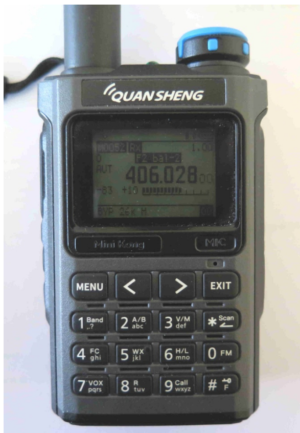
Photo 1 : Le QUANSHENG UV-K1 avec le firmware « IJV 4.0 »
