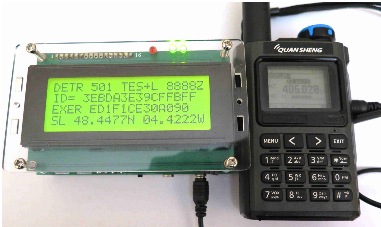
Photo 11 : Essais en décodage 406 : tout fonctionne parfaitement. Première ligne : Code Pays « 501 », c'est très rare !
