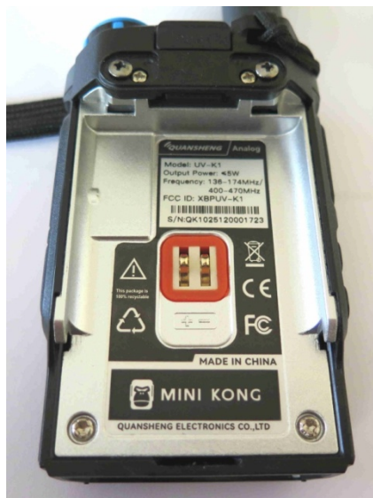
Photo 3 : Pour ouvrir l'UV-K1, il faut démonter les 2 vis Torx dans la partie inférieure, puis soulever la carte avec son blindage.
