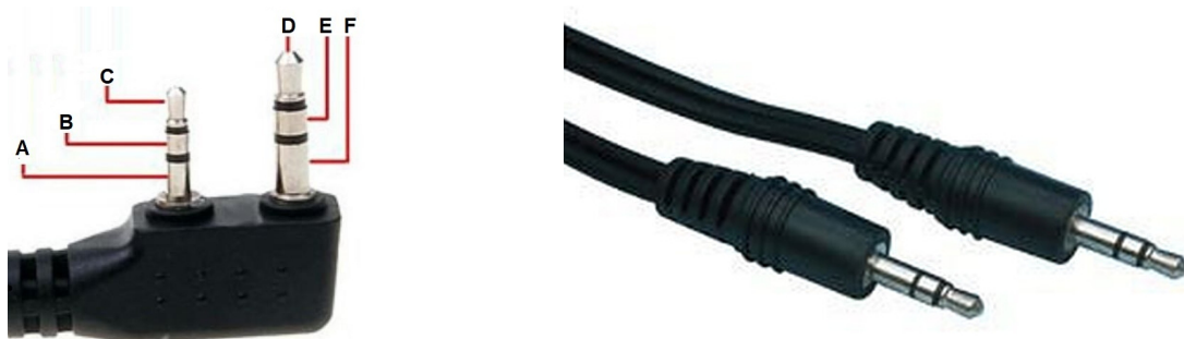
Photo 10 : Sur le connecteur de type K de l'UV-K1, la sortie est sur la pointe (D) et la masse virtuelle sur l'anneau (E). Un simple cordon jack 3,5 suffit pour faire la liaison entre l'UV-K1 et le décodeur (Sce PhA F6GVH)
